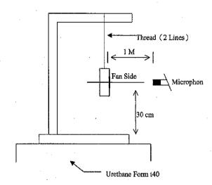
1 METER FROM MICROPHONE TO FAN INTAKE
