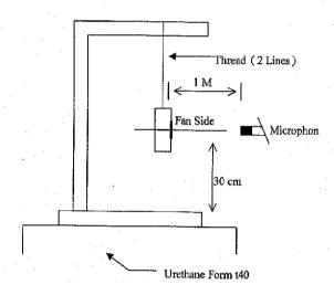
1 METER FROM MICROPHONE TO FAN INTAKE
